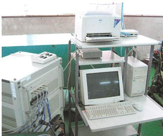
▲電源自動検査装置
